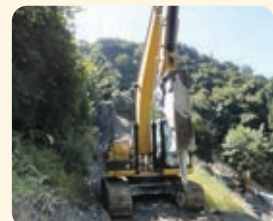
上:ロードヘッダーと呼ばれる大型の掘削機械で採掘。排ガス などで事故が起こらないよう動力は電気です。 左下:発破は使用せず、油圧ブレイカーにより起砕します。
